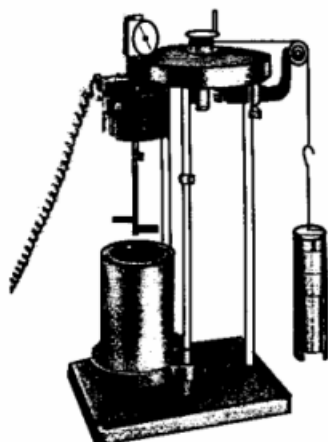
图1 带桨叶式转子和频闪计时器的斯托默黏度计
